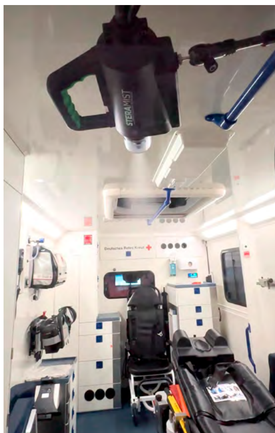
Abb. 6: Düsen, mit denen das Desinfektionsmittel zielgerichtet ausgebracht wird, müssen ggf. auch in der Richtung variiert werden.
