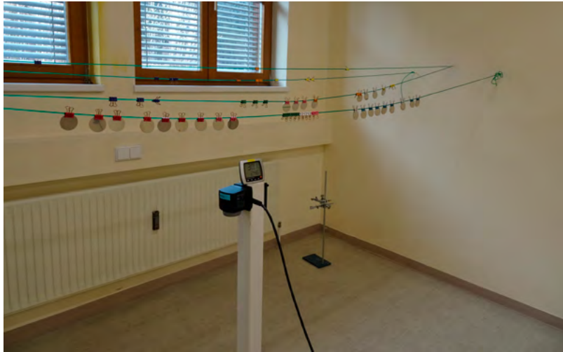
Abb. 2: Generell wird bei der Prüfung nach EN 17272 versucht, die kürzeste Einwirkzeit zu ermitteln, die im Prüfraum und bei den vorgegebenen Bedingungen eine normgerechte Oberflächendesinfektion sicherstellt.
