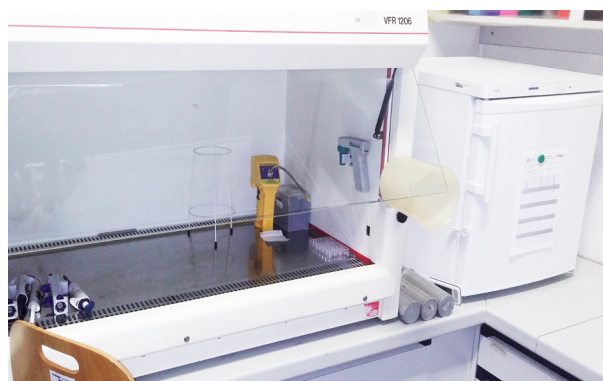
Abbildung 1: Dekontamination eines L2 Laboratoriums mit DCXpert. Die Bioindikatoren wurden auf 4 verschiedenen Positionen verteilt. Das rechte Bild zeigt einen Bioindikator sowie das Gasmessgerät innerhalb einer der Werkbänke. Die Indikatoren wurden am darauffolgenden Tag zur Auswertung gebracht und verblieben für die gesamte Zeit im Raum.
