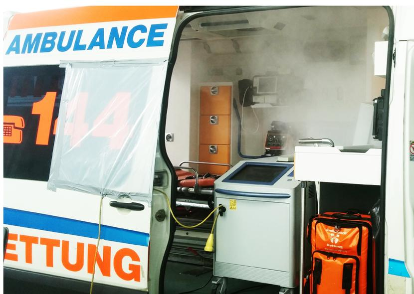
Die Bioindikatoren (*Geobacillus Stearothermophilus*) wurden im Wagen auf verschiedenen Positionen verteilt und im Anschluss an ein Labor zur Auswertung übergeben.
